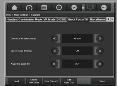
Seleccione Quick Focus para cambiar inmediatamente entre dos planos focales diferentes y Quick Tilt para un flujo de trabajo eficaz en procedimientos quirúrgicos de glaucoma
